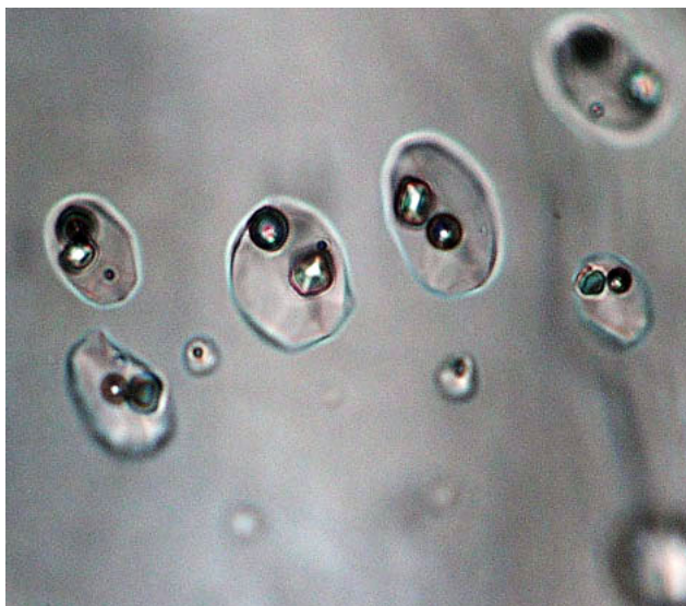
Рис. 23. Флюидные включения гомогенного захвата с дочерними минералами в оптическом флюорите из кепрока соляного купола Нордвик (Таймыр, Россия). Мелкая круглая фаза – самородная сера (Prokofiev et al., 2006)
