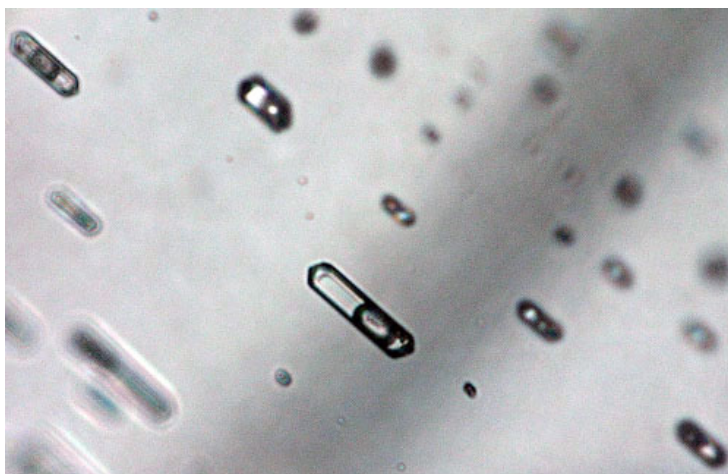
Рис. 5. Первичные флюидные включения вдоль плоскости зоны роста в кристалле кварца
