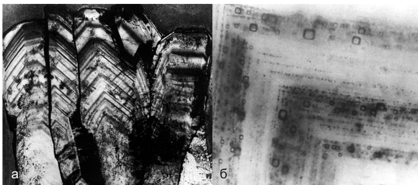
Рис. 4. Расположение флюидных включений по зонам роста в кристаллах кварца (а) и галита (б)
