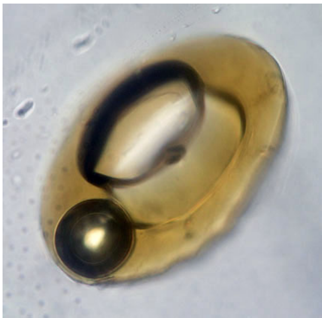
Рис. 17. Флюидное включение с водным раствором и углеводородами (водный раствор, газовая фаза и углеводороды) во флюорите из месторождения Кох-и-Маран (Таджикистан)
