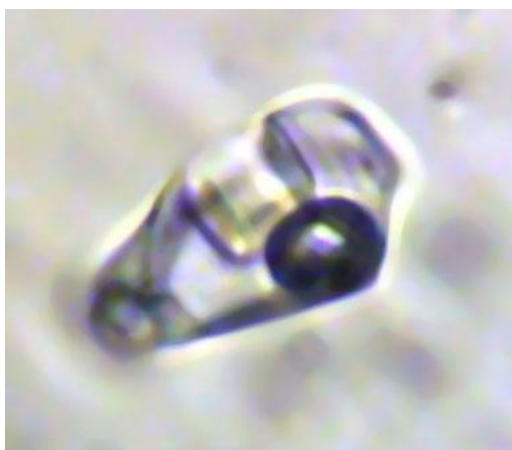
Рис. 33. Флюидное включение с дочерним галитом в кварце гранодиорита из района месторождения золота Банска Штьявница, Словакия. Видна близость величин показателя преломления минерала-хозяина и дочернего минерала
