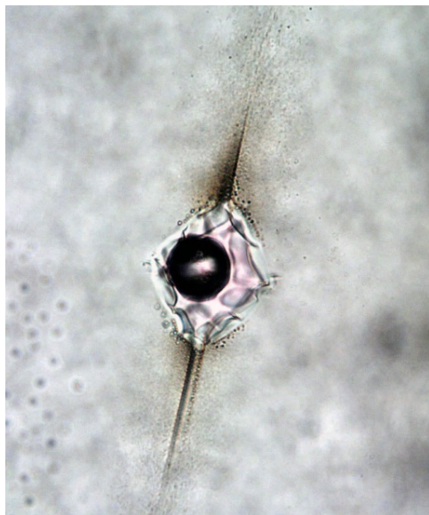
Рис. 30. Растрескивание кварца вокруг включений силикатного расплава в кварцевых вкрапленниках из риолитов Грузии при охлаждении кварца до температуры \alpha - \beta -перехода
